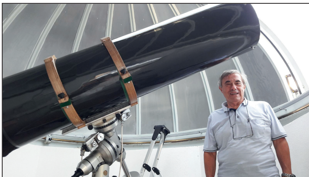
Il dott. Gavioli con il nuovo telescopio da 420mm, tubo di carbonio, da egli stesso progettato e costruito per l'Osservatorio di Stellata. Può raggiungere fino a 700 ingrandimenti
